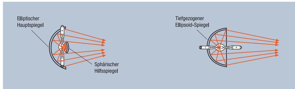
Abb. 20 Optische Konfiguration von „senkrechtem“ und „waagrechtem“ Lampenhaus für Kinoprojektoren.
